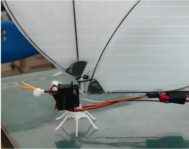
图1舵机-橡皮筋联动传动结构
